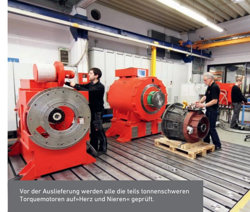
Vor der Auslieferung werden alle die teils tonnenschweren Torquemotoren auf »Herz und Nieren« geprüft.
