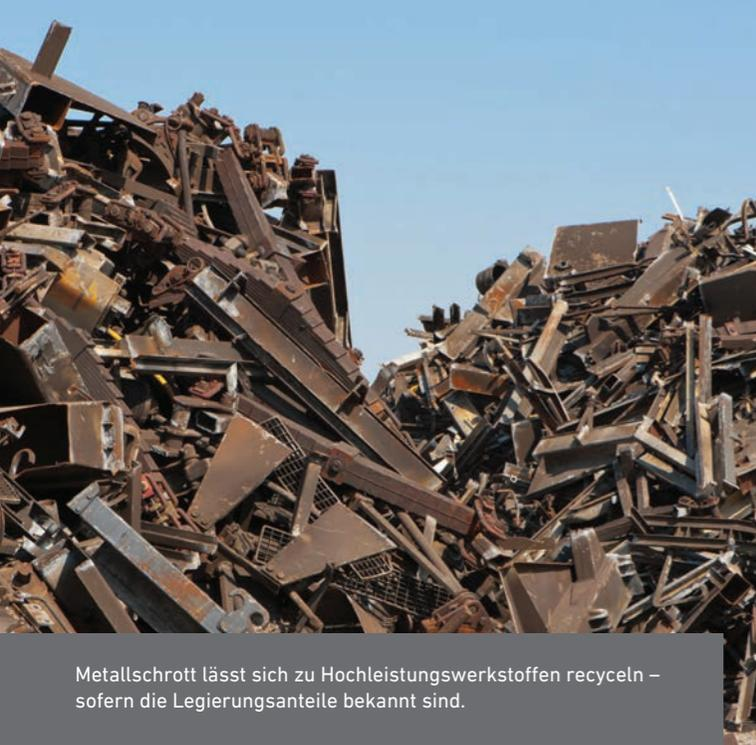
Metallschrott lässt sich zu Hochleistungswerkstoffen recyceln – sofern die Legierungsanteile bekannt sind.
