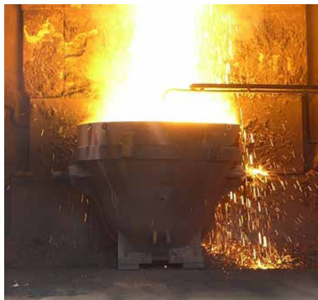
Betriebsversuche bei der Georgsmarienhütte GmbH – flüssige Elektroofenschlacke fällt in den Schlackekübel.
