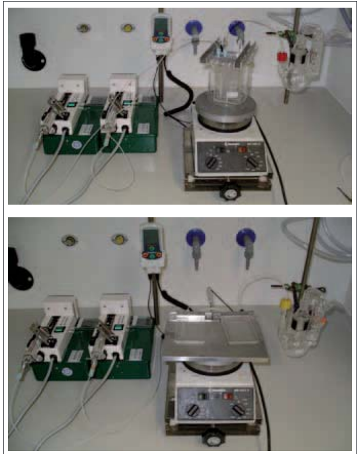
Abb. 10: Vollständige Mikroreaktorapparatur, bestehend aus 2 Spritzenpumpen mit Spritzen, Mikromischer und Verweiler, Auffangkolben mit Blasenähler und Verbindungsschläuchen. Die Temperierung der Reaktoren erfolgt durch Eintauchen in ein Becherglas (oben) oder direkt über eine beheizte Metallplatte (unten).
