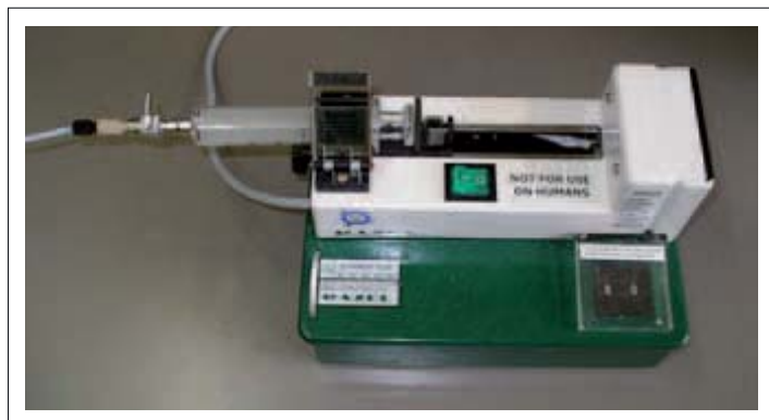
Abb. 4: Einfache Spritzenpumpe mit eingelegter Spritze, Luer/Lock-Absperrhahn und Schlauchanschluss
