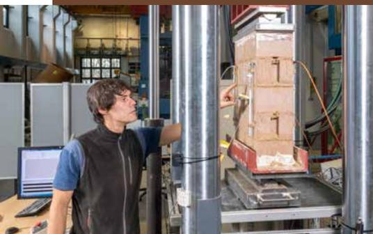
Bauingenieur Phillip Wiehle bei einem Druckversuch an einem Lehmmauerwerkprobekörper
