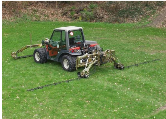
Unterschiedliche naturverträgliche Balkenmäher (Rainer Oppermann, IFAB)
